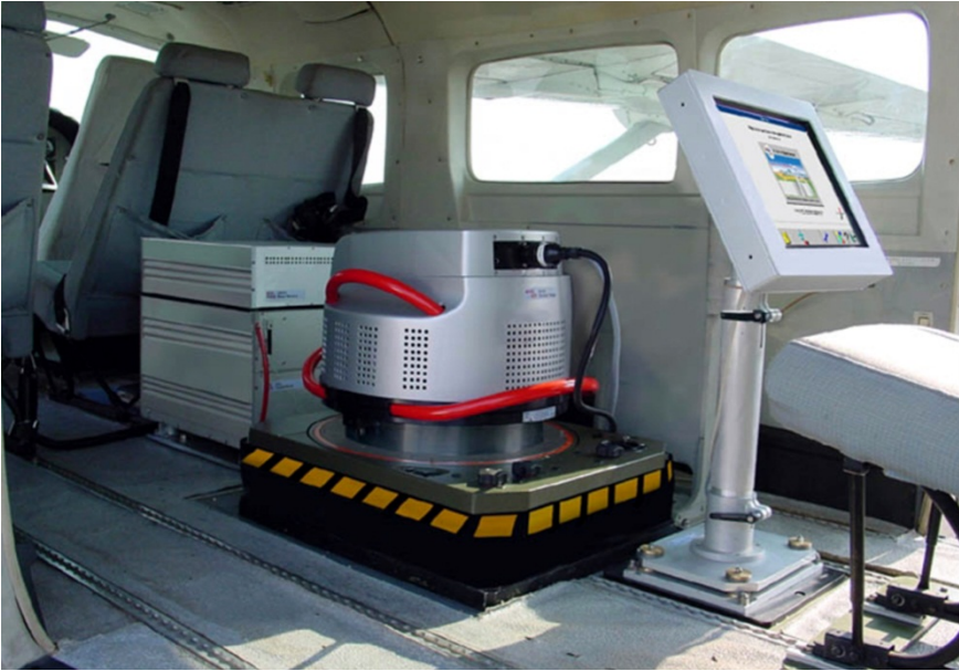
Şekil 48. Hava fotoğrafı kameraları 2000'li yıllardan itibaren dijital hale gelmiştir. Resimde 2001 yılına ait 10 kanallı ve f=62,7 mm odak uzaklığına sahip ADS40 dijital hava fotoğrafı kamerası uçağa monte edilmiş halde görülmektedir.
