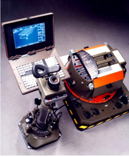
Şekil 42.1990'lı yıllara ait hava fotoğrafı kamerası modeli olan RC30'un özellikleri oldukça gelişmiş olup, mikro işlemci kontrollü, görüntü akışı düzenleyicili ve odak uzaklığı f = 88/153/210/303 mm'dir.
