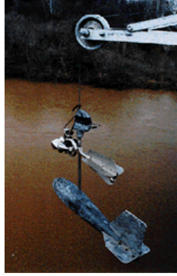
Şekil 2.26. Akarsu akımının hızını belirlemek için kullanılan muline türleri
