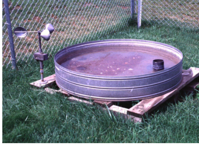
Şekil 2.15. Class A tip buharlaşma tavası ( http://www.crh.noaa.gov ).
