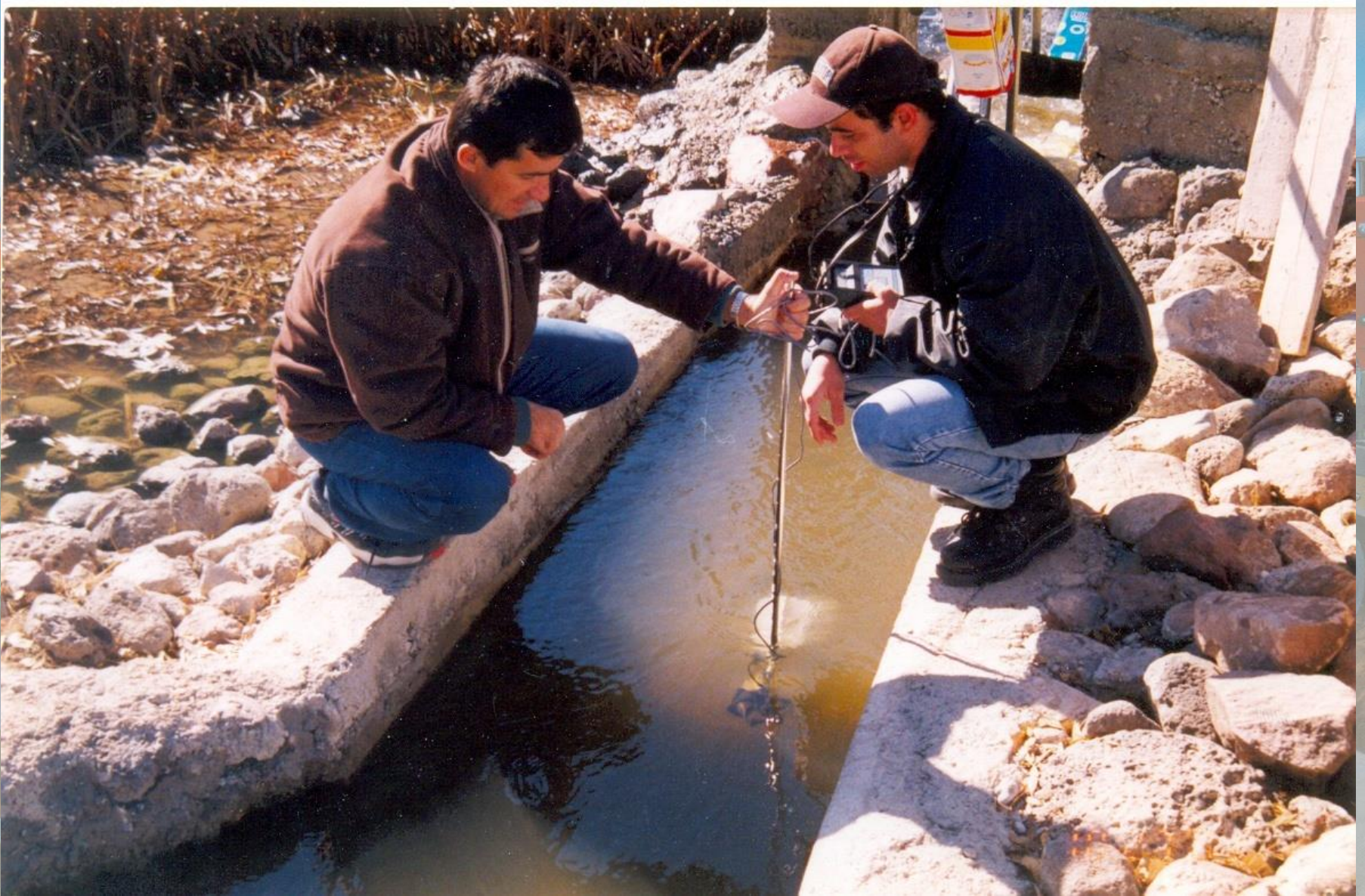
Akarsuda debi ölçümü - Çerkeş (Çankırı), 2003
