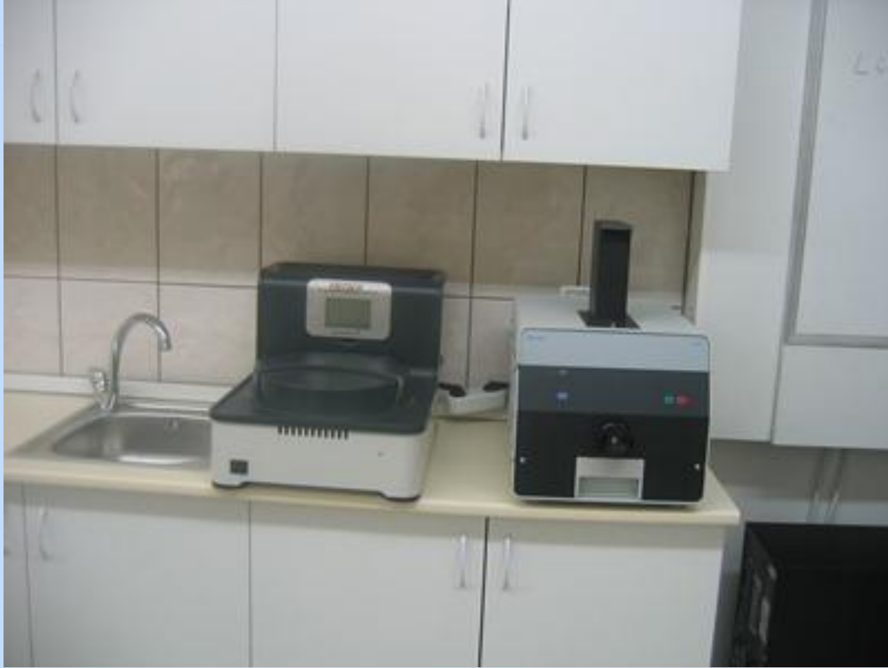
Ankara Üniversitesi Mühendislik Fakültesi Jeoloji Mühendisliği Bölümü Petrografi Uygulama ve Araştırma ve Mikro Analiz-ICP Laboratuvarındaki otomatik taş kırıcı ve öğütücü
