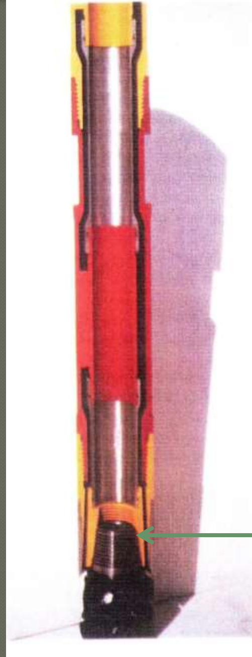
Üç konili matkap ile ters dolaşimli sondaj (Eurodrill, 2006)
