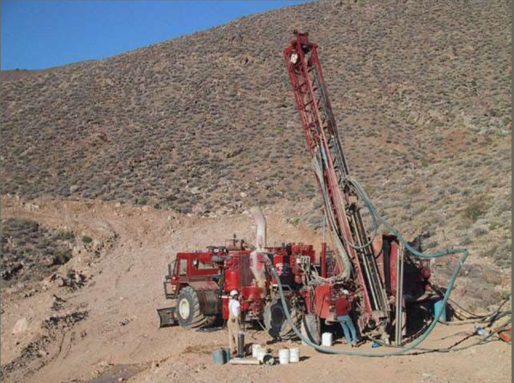
Ters dolaşımlı sondaj uygulaması
