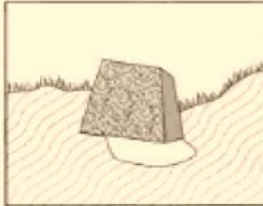
Yapı ayaklarında oluşan erozyon
