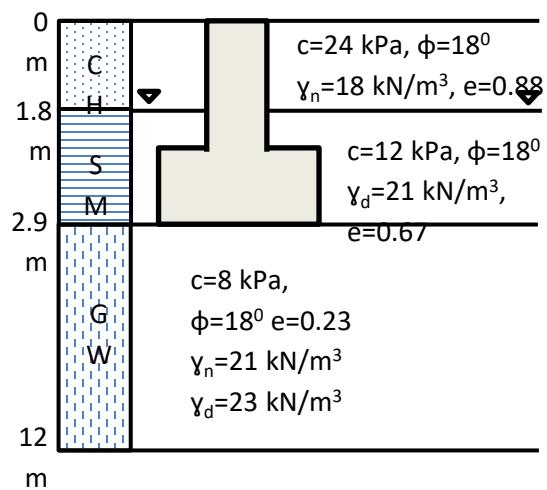
Temel tabanı ve tabandan aşağısı bir B derinliği arasındaki bölgede en düşük değerdeki  $c$ ,  $\phi$  ve  $\gamma$  değerlerini kullanarak taşıma gücü değerlendirilir. Bu bölge taşıma gücü yenilmelerinin meydana geldiği bölgedir ve bu nedenle zemin parametrelerinin kullanılması gereken tek bölgedir. **Kaymanın bir kısmı daha sağlam tabakalarda meydana geldiği için bu yöntem güvenli tarafta kalmaktadır.**
