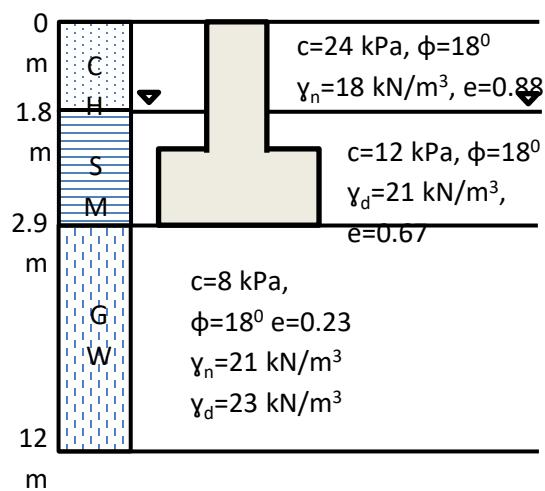
*Temel altında bir seri göçme yüzeyi göz önüne alınır ve şev stabilitesi analizlerinde kullanılan yöntemlere benzer yöntemler kullanılarak her bir yüzey üzerindeki gerilmeler değerlendirilir. En düşük qu değerine sahip yüzey kritik göçme yüzeyi olarak kabul edilir.*
