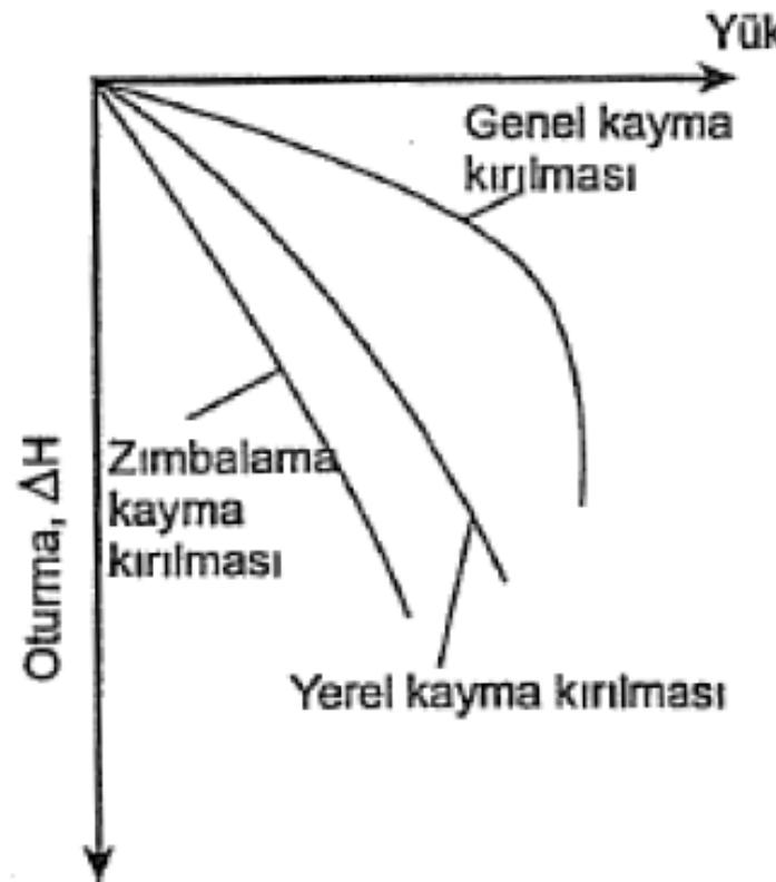
**Yerel kayma kırılması yumuşak veya gevşek zeminlerde meydana gelir.  $\phi < 20^\circ$  yada  $D<0.20$**
