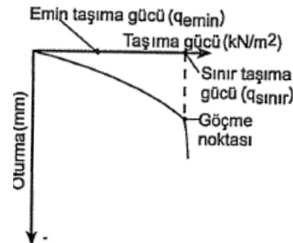
$Q$ : yük,  $q=Q/A$ ; zemine uygulanan basınç,  $Q_{\text{sınır}}$ : temelin göçmesine veya temel zemininin kırılmasına neden olan toplam yük
