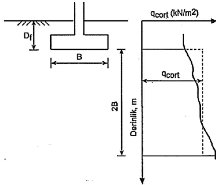
$q_{cort}$ ; Temel taban düzeyinden itibaren 2B derinliği için ortalama koni uç direnci  $q_{or,t}$ ,  $q_{emin}$ : kN/m<sup>2</sup>
