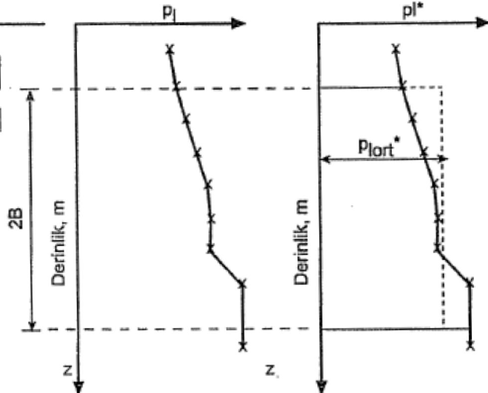
$p_{l,ort}^*$ : Temel taban düzeyinden itibaren  $2B$  derinliği boyunca, ortalama net limit basıncı. PMT deneyinden elde edilen  $p_l$ - $z$  ilişkisi önce  $p_l^*-z$  ilişkisine dönüştürülür. Herhangi bir derinlikteki net limit basınç,  $p_l^*$ , aşağıdaki bağıntı ile elde edilir.
