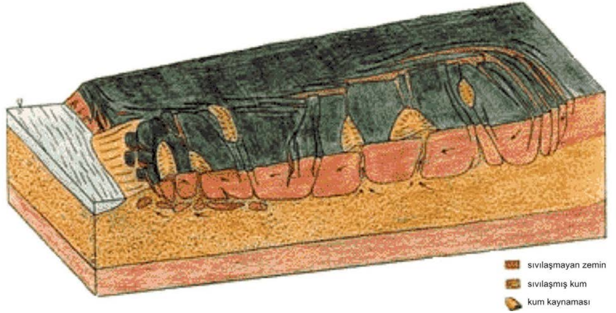
2001 Nisqually depremi Green River boyunca oluşan yanal yayılma
