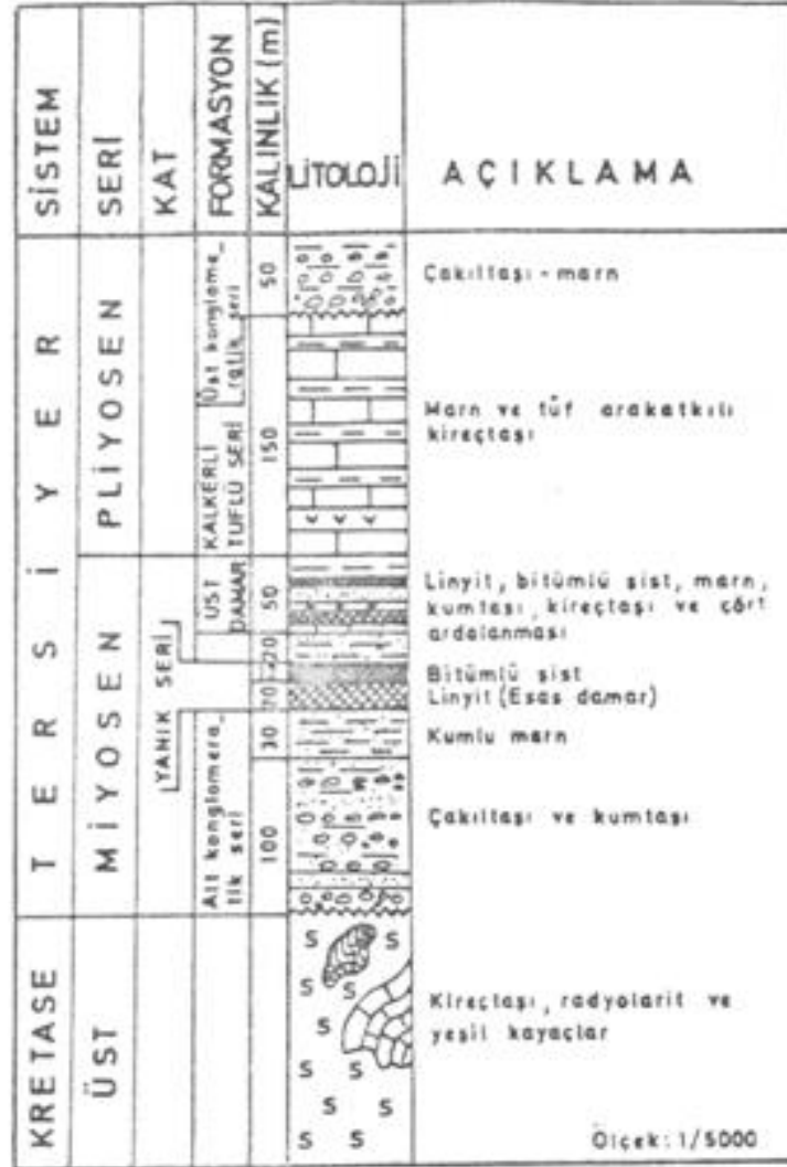
Şekil 5.6 : Seyitömer bitümlü sist sahasının stratigrafik tip kesiti
